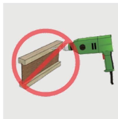
Ne pas percer la membrure
