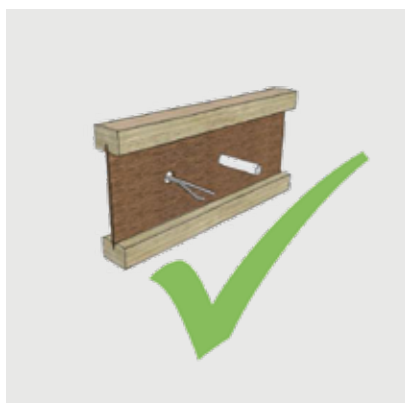
Les câbles doivent traverser l'âme de la poutre
