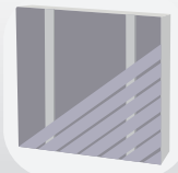
Pose diagonale simple lambourde
